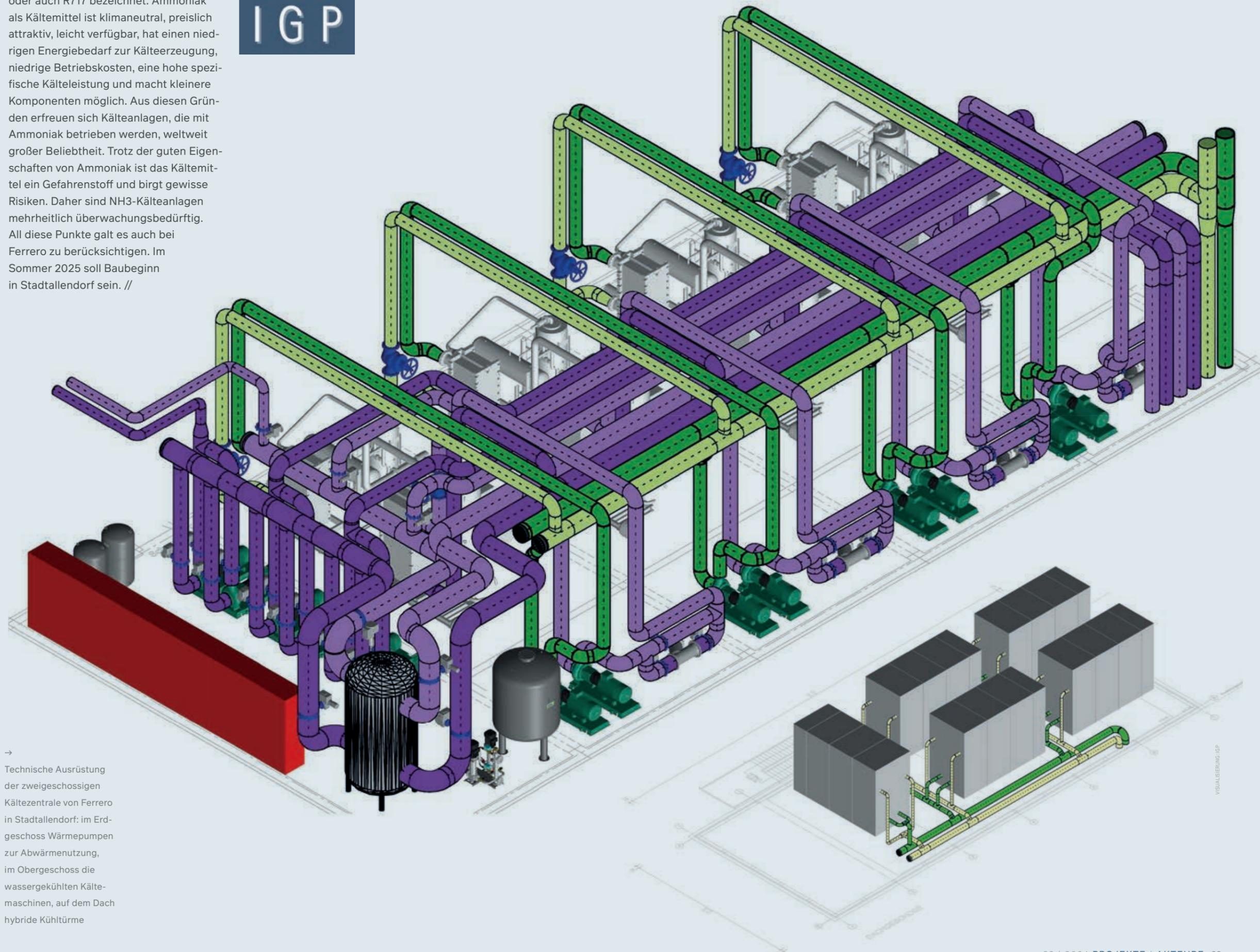
→ Technische Ausrüstung der zweigeschossigen Kältezentrale von Ferrero in Stadtallendorf: im Erdgeschoss Wärmepumpen zur Abwärmenutzung, im Obergeschoss die wassergekühlten Kältemaschinen, auf dem Dach hybride Kühltürme
