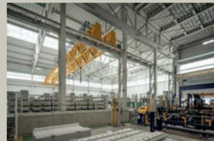
↑ Der Hallenkran mit 25 t Traglast
